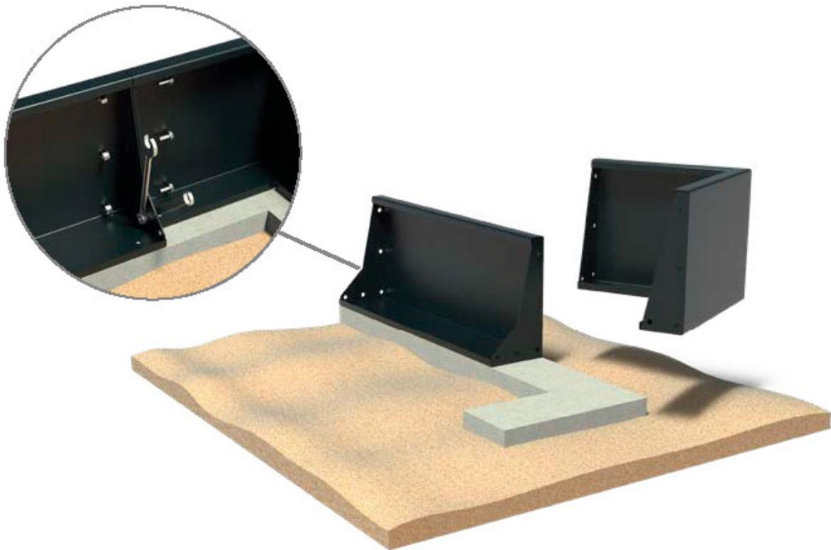
3. Fournir au mur de soutènement une couche de terre des deux côtés de 10 cm au-dessus de la plaque de base pour la stabilité nécessaire.
