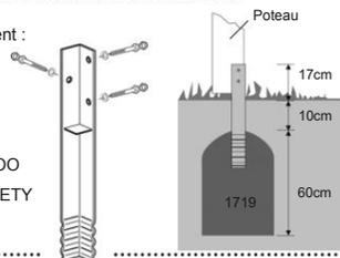
Fondations en béton = mélange de sable et de gravier de granulométrie 0/32 plus ciment dans un rapport de mélange de 3:1.
