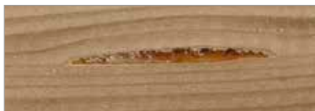
éliminer les poches de résine à l'aide d'un produit de déshuilage
