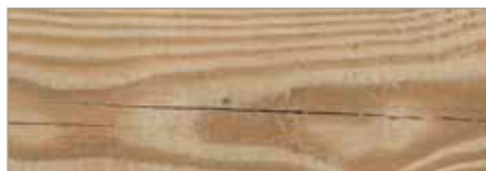
Fissures de séchage (autorisées par la norme DIN)
