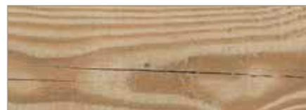
*Fissures de séchage (autorisées par la norme DIN)*
