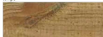
Retravailler à la main les zones de rabotage rugueuses
