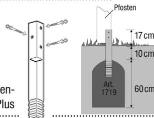
Fundamente aus Beton = Sandkiesgemisch Körnung 0/32 plus Zement im Mischungsverhältnis 3:1.
