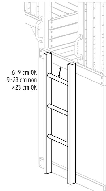
Dans le cas d'une plateforme de 150 cm de hauteur, **raccourcir l'échelle** proportionnellement. Coupez l'échelle en évitant une ouverture critique entre 9 et 23 cm (voir règles sur les différences de niveau).
