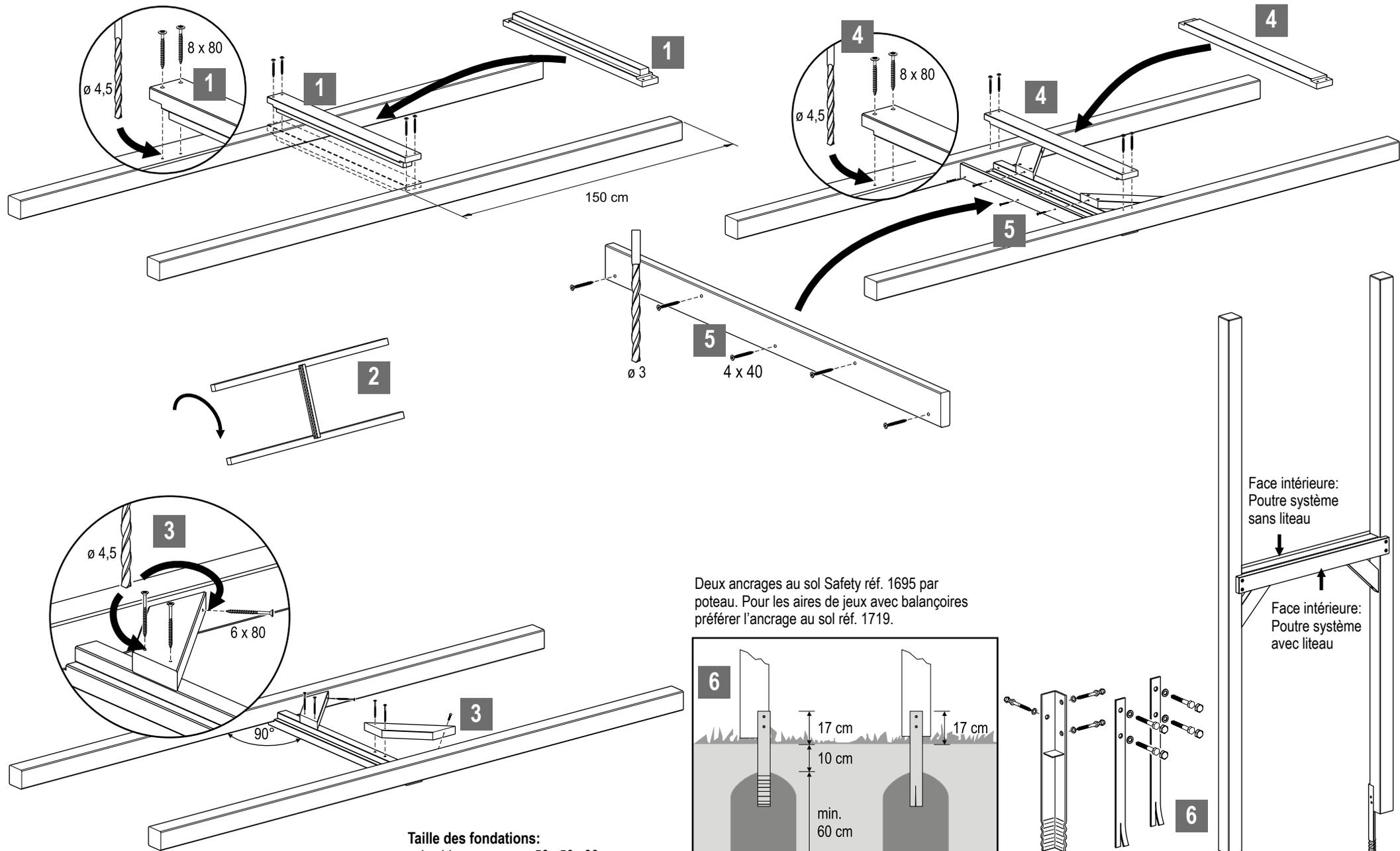
Deux ancrages au sol Safety réf. 1695 par poteau. Pour les aires de jeux avec balançoires préférer l'ancrage au sol réf. 1719.
