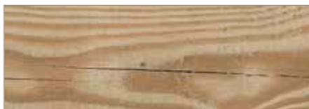
Fissures de contrainte (conformes à la norme DIN)
