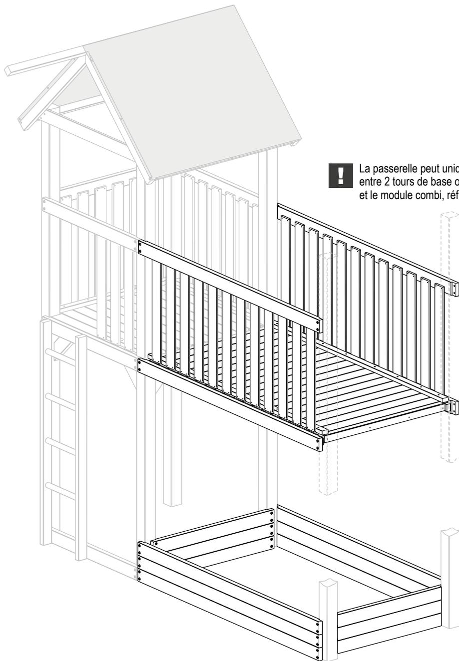
**!** La passerelle peut uniquement être montée entre 2 tours de base ou entre 1 tour de base et le module combi, réf. 1740.
