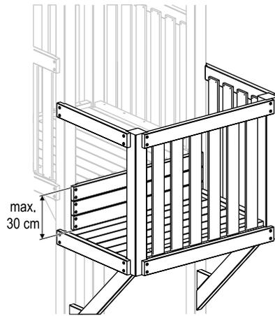
**Les différences de niveau** - comme dans ce cas par rapport au balcon - devraient mesurer maximum 30 cm en hauteur. Veuillez fermer ces ouvertures pour des raisons de sécurité avec les poutres du système. (Réf. 1663)
