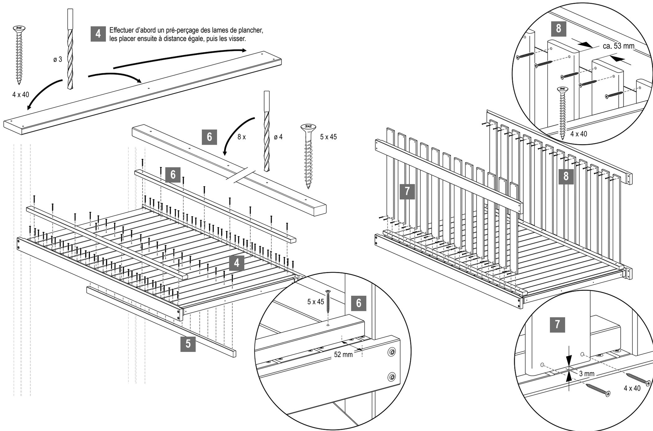
4 Effectuer d'abord un pré-perçage des lames de plancher, les placer ensuite à distance égale, puis les visser.
