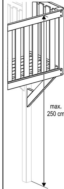
La hauteur maximale du bord supérieur d'une rambarde ne doit jamais dépasser 250 cm mesurés depuis le sol. Cela correspond à une hauteur de plateforme de 170 cm.
